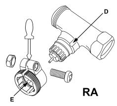
Achten Sie bei der Montage bitte darauf, dass die Zapfen im Inneren des Adapters (E) eine deckungsgleiche Position zu den Einkerbungen (D) am Ventil haben.
