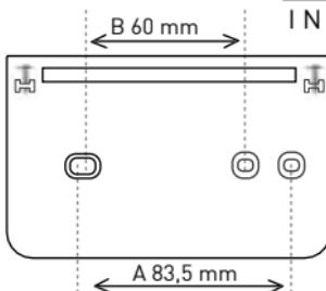
Um den Befestigungssockel vom vorderen Körper zu trennen, den Deckel des Batteriefachs entfernen, und die Schrauben von oben abschrauben, indem Sie den Körper des Geräts zum Ausziehen nach unten drehen.
