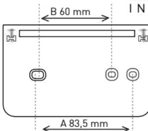
Para separar del cuerpo frontal el zócalo para la fijación, sacar la tapa del hueco para pilas y destornillar los tornillos hacia arriba, girando el cuerpo del aparato hacia abajo para extraerlo
