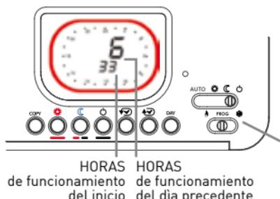
Con C57RF es posible saber por cuantas horas el calor ha sido solicitado el día precedente (relé cerrado - ON) y desde el principio de funcionamiento de Intellitherm (colocación de las pilas o reseteado).
