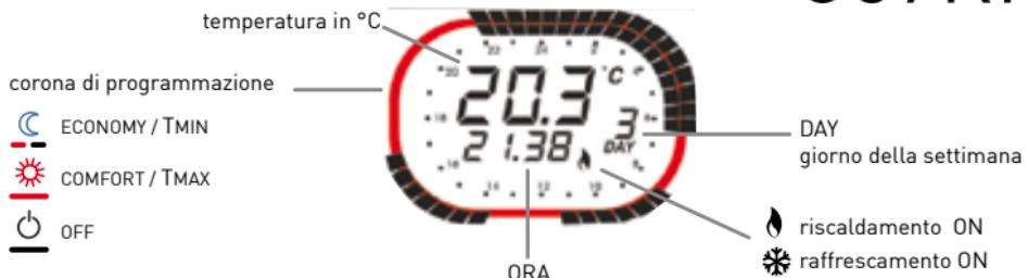
La corona di programmazione rappresenta un orologio di 24 ore suddiviso in settori di 30 minuti. Il colore dei settori indica la temperatura programmata per quel periodo di tempo.
