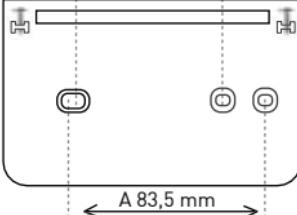
Per separare dal corpo frontale lo zoccolo per il fissaggio, togliere il coperchio del vano porta pile e svitare dall'alto le viti, ruotando il corpo dell'apparecchio verso il basso per estrarlo.
