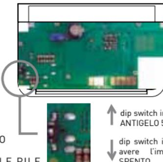
↑ dip switch in ALTO per la protezione ANTIGELO 5°C
