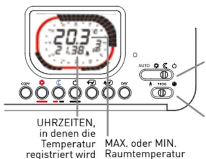
Mit Intellitherm C57RF ist es möglich, die MIN. und MAX. Temperatur, die der Raum am vorhergehenden Tag erreicht hat, sowie die Uhrzeit der Messung zu überprüfen.
