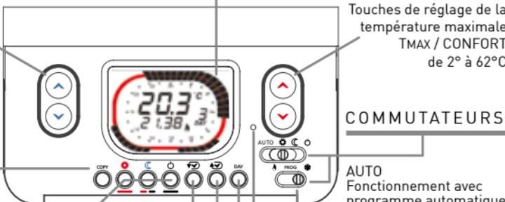
Touches de réglage de la température maximale
