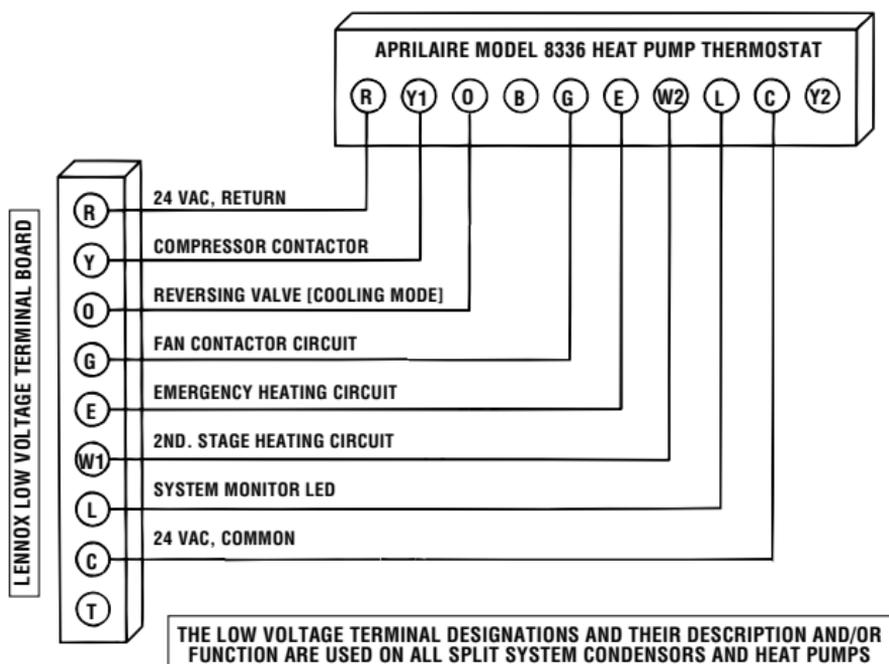
**APRILAIRE MODEL 8336 HEAT PUMP THERMOSTAT CONVERSION TO LENNOX HP19 AND HP20 HEAT PUMP SYSTEMS**
