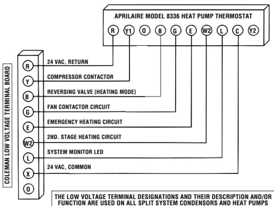
**APRILAIRE MODEL 8336 HEAT PUMP THERMOSTAT CONVERSION TO COMFORTMAKER
