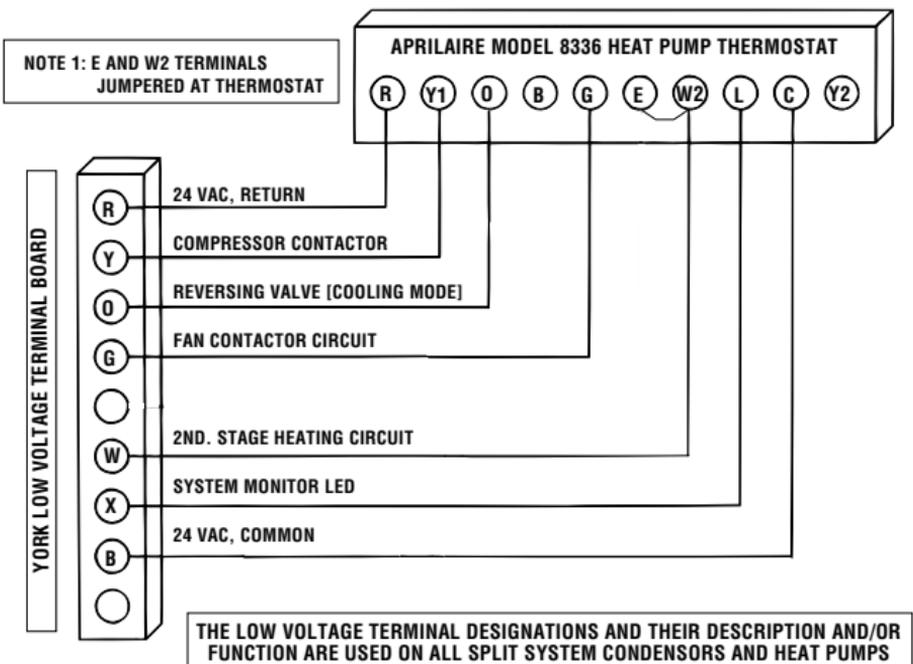
**APRILAIRE MODEL 8336 HEAT PUMP THERMOSTAT CONVERSION TO LENNOX CB19 HEAT PUMP SYSTEMS**
