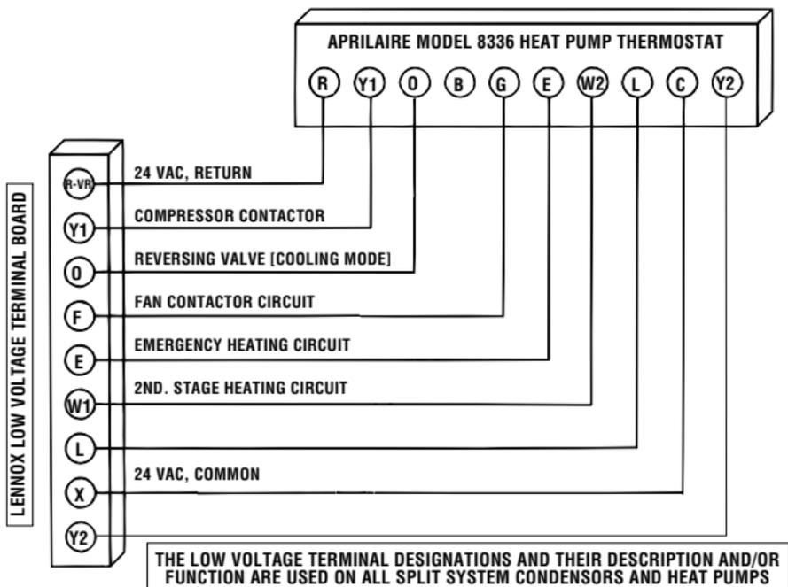
**APRILAIRE MODEL 8336 HEAT PUMP THERMOSTAT CONVERSION TO LENNOX HP22 WITH CB19 PCB HEAT PUMP SYSTEMS**
