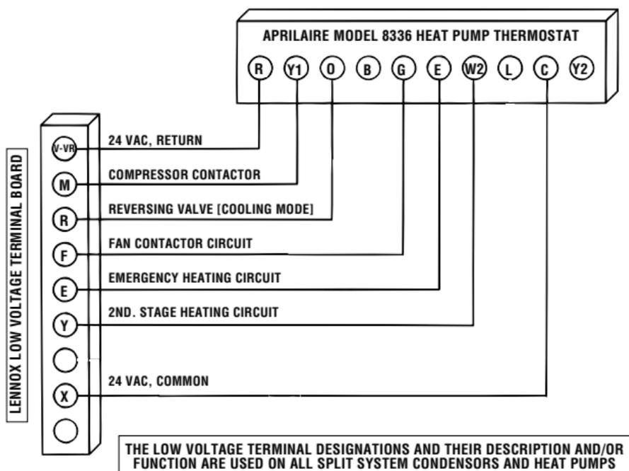
**APRILAIRE MODEL 8336 HEAT PUMP THERMOSTAT CONVERSION TO LENNOX HP21 WITH CB21 PCB HEAT PUMP SYSTEMS**
