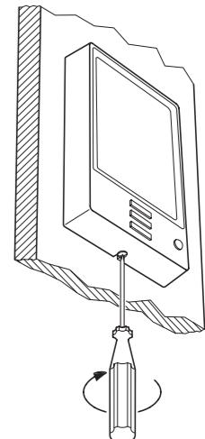
Vuelva a instalar la placa frontal. Apriete el tornillo en la parte inferior. Realice las prueba del GFCI/EGFPD.
