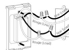
Assurez-vous de serrer fermement les borniers de connexion pour un branchement sécuritaire. Une connexion mal exécutée peut représenter un risque d'incendie.
