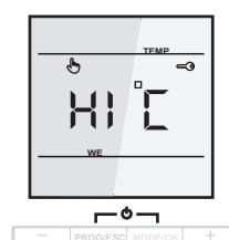
**HI °C** Anzeige für den Fall, dass eine Temperatur höher als +45°C erreicht wird.
