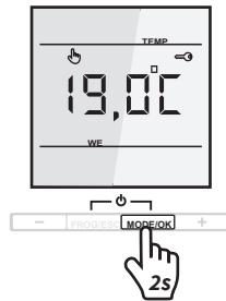
Wenn Sie die MODE/OK Taste erneut für 2 Sek. drücken, wechselt die Anzeige wieder zur Bodentemperatur.
