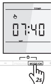
Der voreingestellte Bildschirmschoner ist die Bodentemperatur. Drücken und halten Sie die MODE/OK Taste für 2 Sek. Die Anzeige wechselt zur aktuellen Uhrzeit.
