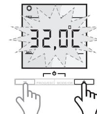
Stellen Sie die Temperatur, welche Sie während des COMFORT Temperaturprofils wünschen mit Hilfe der „+“ oder „-“ Tasten ein.
