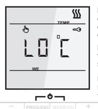
**LO °C** Anzeige für den Fall, dass die Heizung nicht in der Lage ist, den Boden um mehr als +5°C zu erwärmen.
