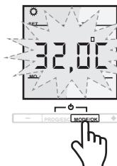
Bestätigen Sie auch diese Eingabe mit der MODE/OK Taste. Das Display zeigt nach Abschluss der Einstellungen die aktuelle Temperatur an.
