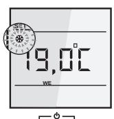
Wählen Sie den Programmbetrieb mit Hilfe der „-“ Taste.
