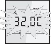
Die Bodentemperatur mit Hilfe der „+“ oder „-“ Taste einstellen.
