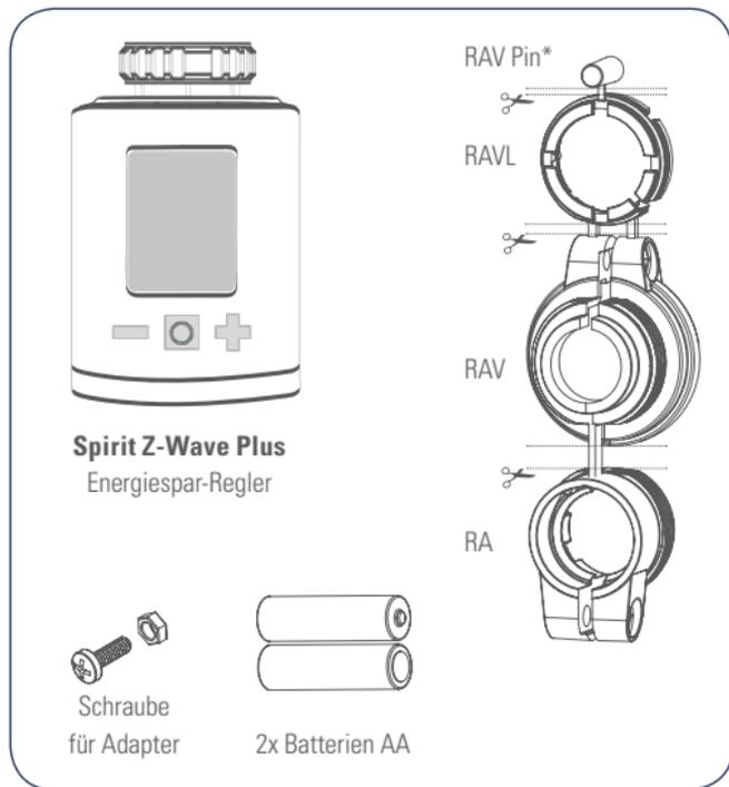
\* Bei Verwendung des RAV-Adapters, benötigen Sie den RAV Pin zur Verlängerung des Ventilstößels.
