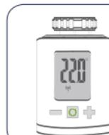
Nach erfolgreicher Installation **drücken Sie die grün blinkende Boost-Taste**, um die Adaptierung zu starten. Nach abgeschlossener Adaptierung zeigt das Display die Solltemperatur an.
