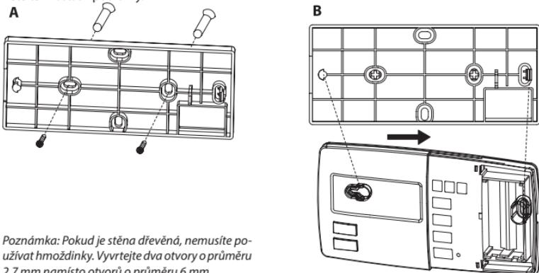
**Poznámka:** Pokud je stěna dřevěná, nemusíte používat hmoždinky. Vyvrťte dva otvory o průměru 2,7 mm namísto otvorů o průměru 6 mm.
