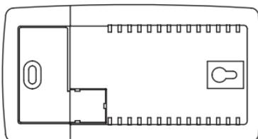
Efectuați în perete două găuri cu diametrul de 6 mm.
