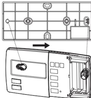
Bemerkung: Bei einer Holzwand müssen keine Dübel benutzt werden. In die Wand zwei Löcher mit Durchmesser 2,7 mm anstelle 6 mm bohren.
