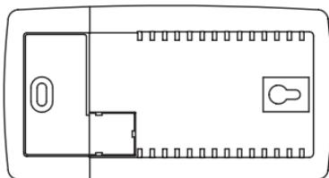
Примітка: якщо стіна дерев'яна, не обов'язково використовувати дюбеля. Просвердліть два отвори діаметром 2,7 мм замість отвору діаметром 6 мм.
