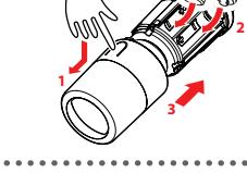
**DK:** Sådan monteres termostaten. Fjern batteridækslet som vist på diagrammet, og indsæt to AA-batterier. Sorg for, at batteriene er korrekt orienterede. Skru Danfoss Eco™ på den monterede adapter, indtil der høres en kliklyd. Tryk og hold knappen nede i 3 sekunder. Sætpunktet for temperatur vises på skærmen når Danfoss Eco™ er monteret.
