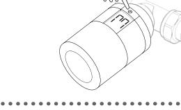
**CZ:** Jak připojit termostat. Odejměte kryt baterie podle obrázku a vložte dve AA baterie. Ujistěte se, že jsou baterie správně orientovány. Našroubujte Danfoss Eco™ na připojený adaptér, dokud se neozve cvaknutí. Stiskněte a držte tlačítko po dobu 3 sekund. Po připojení Danfoss Eco™ se na obrazovce zobrazí nastavená teplota.
